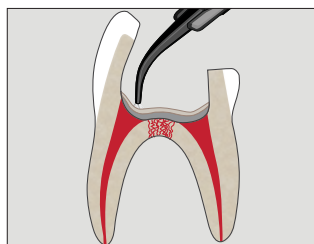
3. Aplique una fina capa del forro cavitario Ultra-Blend™ liner plus.
