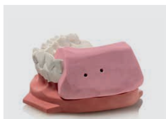
6. Recolocación de la llave sobre el modelo máster
